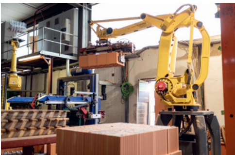
Die 'Stopfanlage': hier werden die Steine mit Mineralwolle gefüllt
