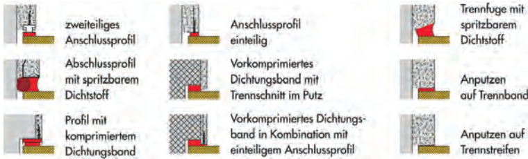
Bild 75. Putzanschlüsse an Fensterprofile [66]
