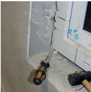
Bild 137. Beschädigungen nach mechanischem Angriff (Widerstandsklasse RC 2); a) linke Laibungsseite mit und b) rechte Laibungsseite ohne Armierungsputz mit Gewebeeinlage (Foto: Dr. Meyer)
