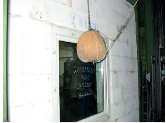
Bild 115. Dynamischer Versuch mit einem Sandsack (30 kg) [109]
