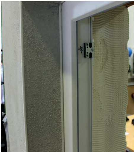
Bild 135. Eingeputztes Fenster vor dem Versuch; a) Außenseite, b) Innenseite der von außen gesehenen linken Laibungsseite mit Armierungsputz mit Gewebeeinlage (Foto: Dr. Meyer)
