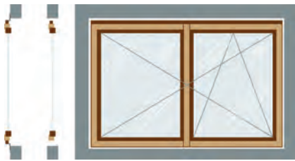
Bild 30. Fenster in Fassadenöffnung bzw. vor der Fassade [3]
