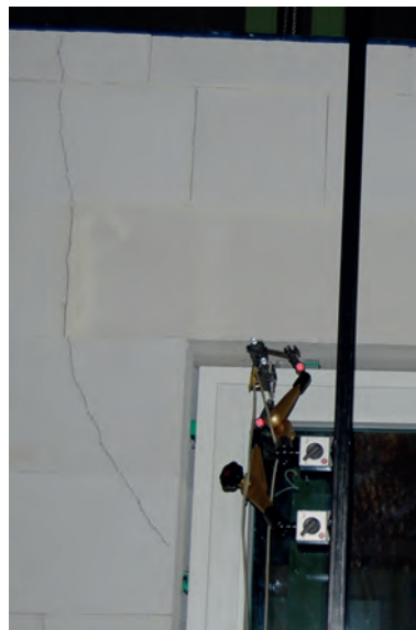
Bild 122. Statische Druckbelastung der Verriegelungspunkte und Rissbildung in der Wandecke [108]
