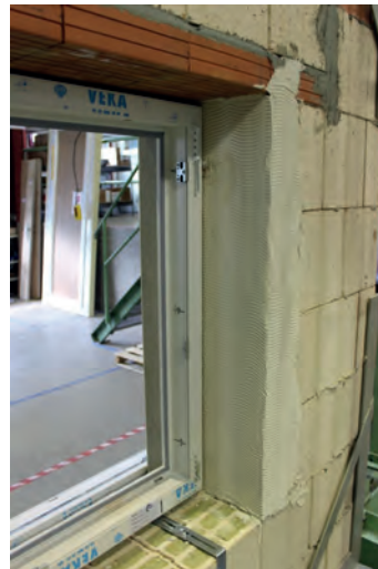
Bild 135. Eingeputztes Fenster vor dem Versuch; a) Außenseite, b) Innenseite der von außen gesehenen linken Laibungsseite mit Armierungsputz mit Gewebeeinlage (Foto: Dr. Meyer)
