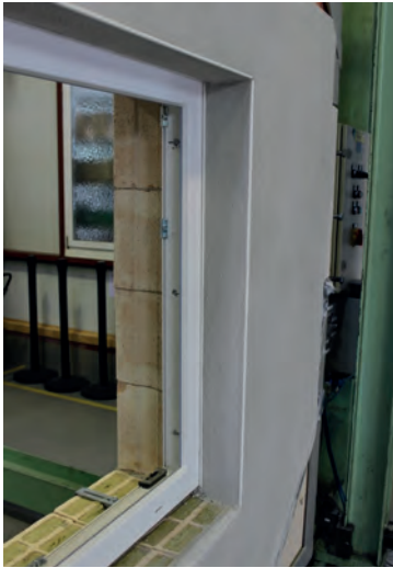
Bild 136. Eingeputztes Fenster vor dem Versuch; a) Außenseite, b) Innenseite der von außen gesehenen rechten Laibungsseite (Foto: Dr. Meyer)
