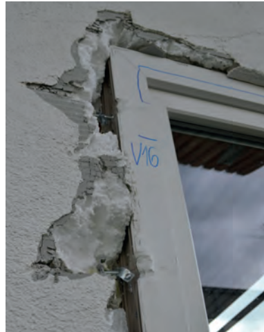
Bild 143. Manueller Angriff auf die Verbindung Konsole – Fensterprofil [111]
