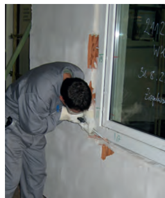
Bild 119. Manuelle Einbruchprüfung; a) Porenbetonwand (hier Angriff auf das Fenster), b) Hochlochziegel (hier Angriff auf den Verankerungsgrund) [109]
