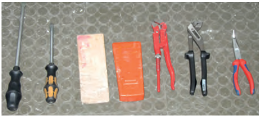
Bild 117. Im Rahmen der Widerstandsklasse WK-2-Prüfung verwendeter Werkzeugsatz [109]
