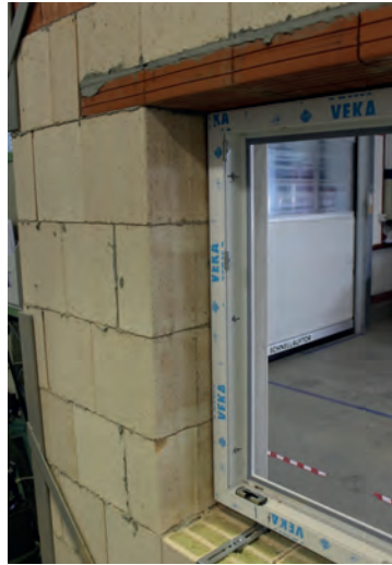
Bild 136. Eingeputztes Fenster vor dem Versuch; a) Außenseite, b) Innenseite der von außen gesehenen rechten Laibungsseite (Foto: Dr. Meyer)
