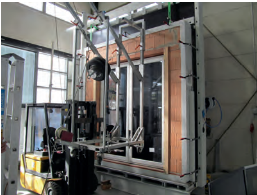
Bild 76. Simulation einer unplanmäßigen Nutzung mit einem Doppelreifenpendel [60]
