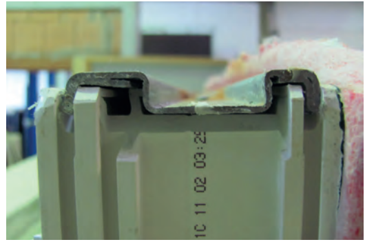
Bild 55. Oberseitige Verstärkung des Fensterprofils mit zusätzlichem Stahlprofil [60]
