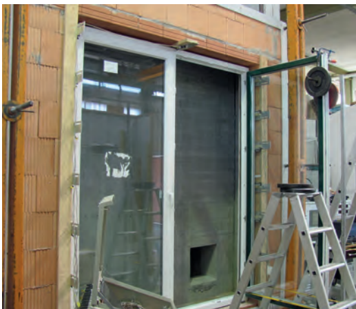
Bild 65. Versuch zur Überprüfung der Verformung bei statischer Zusatzlast am Fensterflügel [60]
