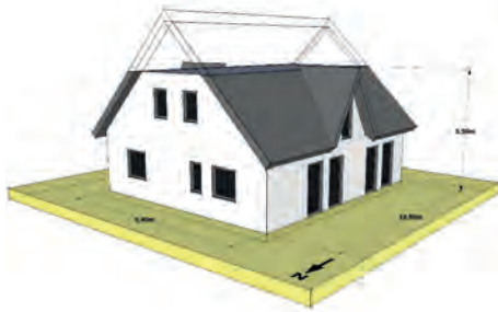
Bild 6. Beispielhafte Ermittlung des spezifischen Transmissionswärmeverlust H_T'
