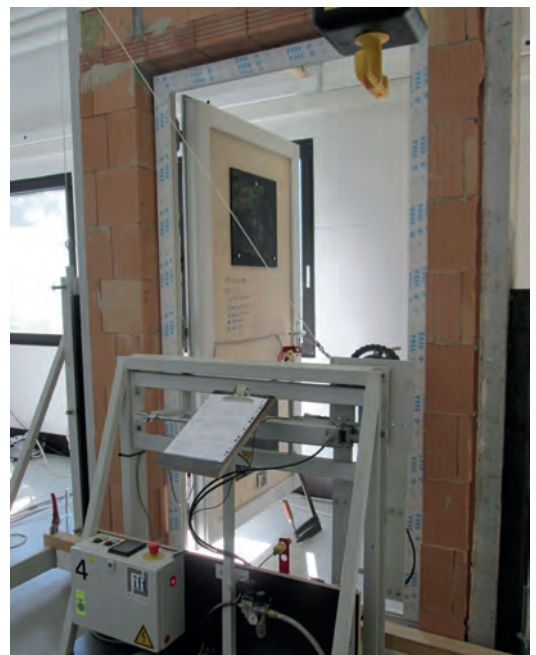
Bild 70. Haustür zur Prüfung der möglichen Öffnungs- und Schließvorgänge
