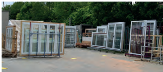
Bild 34. Fenster zur Prüfung in starrem Stahl- oder Holzrahmen montiert
