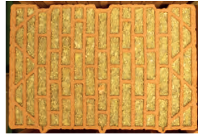
Bild 138. In den Versuchen verwendeter Wärmedämmziegel mit Kleinlochung (unipor W07 – Zulassung Z-17.1-1074)
