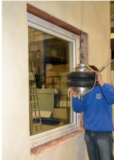
Bild 129. Dynamischer Versuch in der Klasse RC 2 mit einem Doppelreifenpendel (50 kg) [110]
