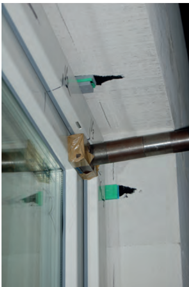
Bild 122. Statische Druckbelastung der Verriegelungspunkte und Rissbildung in der Wandecke [108]
