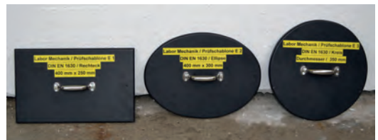
Bild 116. Schablonen zur Ermittlung einer „durchgangsfähigen Öffnung“
