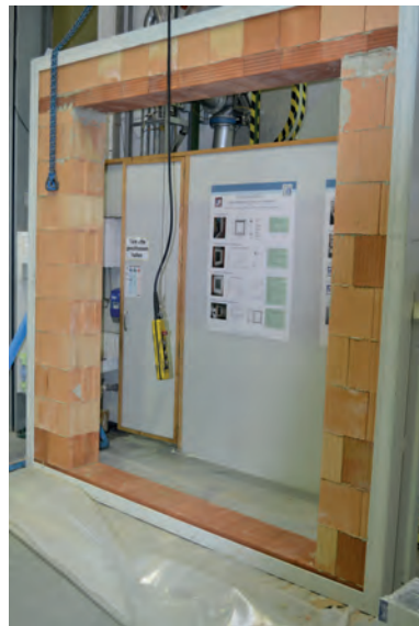
Bild 53. Rohbauöffnung in der „Versuchswand“ mit zusätzlichem Ziegelsturz an der Unterseite
