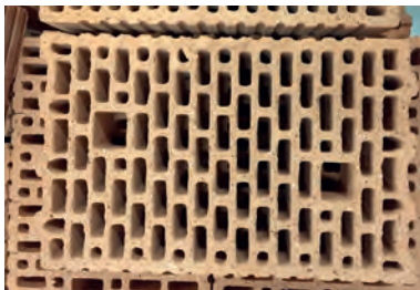
Bild 131. In den Versuchen verwendeter Plan HLzB 6-0,9 (Foto: Dr. Meyer)
