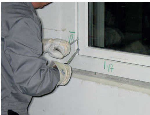
Bild 119. Manuelle Einbruchprüfung; a) Porenbetonwand (hier Angriff auf das Fenster), b) Hochlochziegel (hier Angriff auf den Verankerungsgrund) [109]
